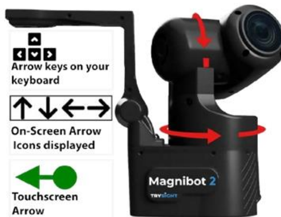
Rys. Prezentacja sposobu sterowania ruchem kamery MagniBot 2.
