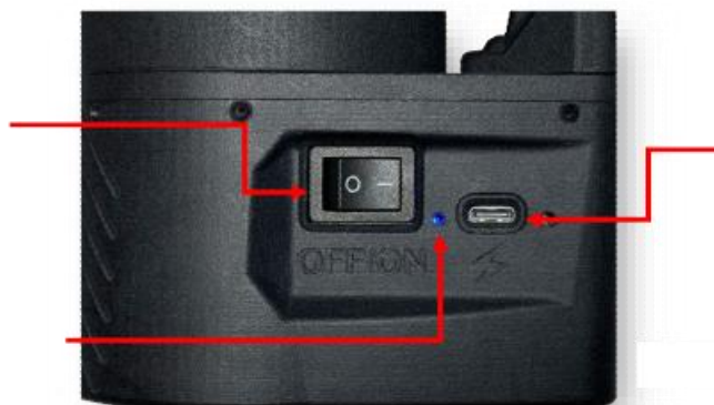
Rys. Prezentacja sposobu włączania MagniBot 2. Czerwone strzałki wskazują przycisk zasilania (włączania / wyłączania), świecącą na niebiesko diodę i port ładowania.
