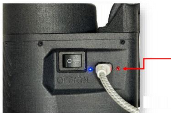
Rys. Prezentacja sposobu ładowania kamery MagniBot 2. Przewód jest wetknięty do portu ładowania, świecą obie diody – niebieska, wskazująca, że urządzenie jest włączone i czerwona, wskazująca, że trwa ładowanie.
